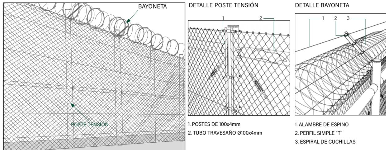
Valla formada por poste de diámetro 100x4mm y malla simple torsión de 50/16. Los postes intermedios se colocan cada 2m50 y los postes tensión cada 25m00. Se deberán instalar 6 hiladas de tensión fabricadas con alambre nº16.
